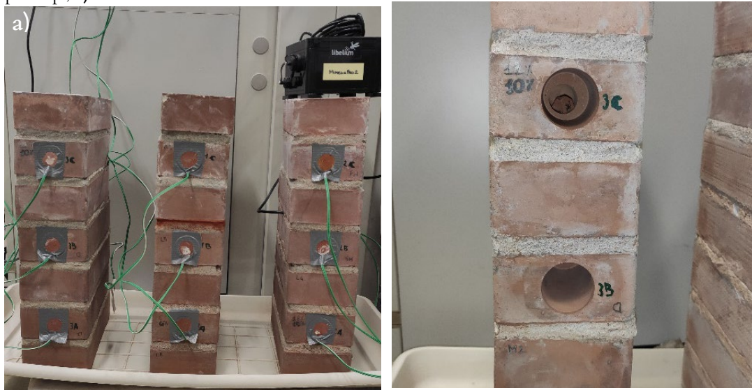
Fig. 3 – a-b Test del sistema sensorizzato su prototipi di muratura in laboratorio: a) vista di insieme dei tre prototipi; b) vista di uno dei fori di misura
