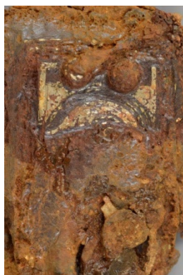
Fig. 10 Pulitura meccanica con micromotore e punta diamantata su elemento 6
