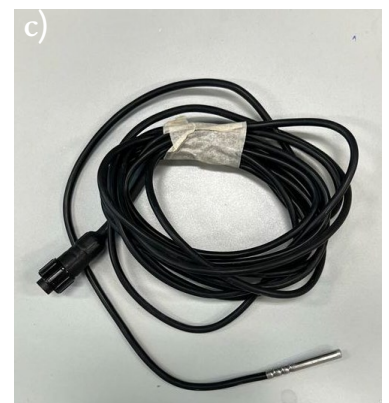
Fig. 1 – a) sensori di umidità Watermark Soil Moisture Sensor, irrometer Co.; b) centralina di acquisizione Plug&Sense! Smart Agriculture Pro Wi-fi, Libelium; c) sensori di temperatura PT-1000, Libelium
