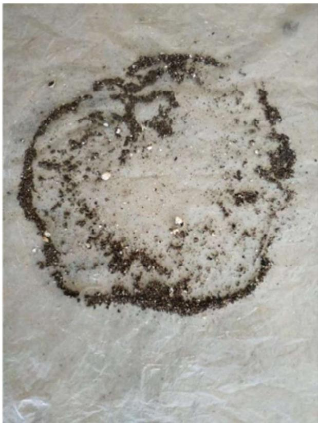
Fig. 3 - Esempio di residuo di flottazione di un campione di sedimento.
