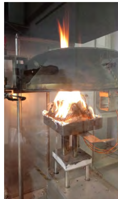
Fig. 3 Prove di reazione al fuoco con il cono calorimetro (metodo ISO 5660) eseguite nel Laboratorio Polimeri del Centro ENEA di Brindisi
