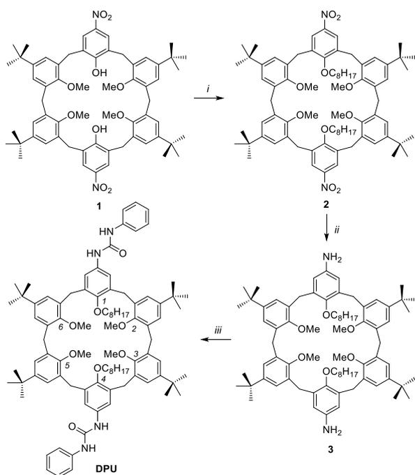
**Scheme 1.** Reagents and conditions: *i*) 1-iodooctane,  $K_2CO_3$ ,  $CH_3CN$ , reflux, 4d, 70%; *ii*)  $NH_2NH_2 \cdot H_2O$ , Pd/C, EtOH, reflux, 24 h and *iii*) phenyl isocyanate,  $CH_2Cl_2$ , rt, 2h, 80% (two steps).
