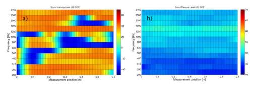
Figure 8 - Livelli di intensità e di pressione sonora (dB) misurati sul lato del campione. La sorgente si trova a sinistra dell'area del grafico - Sound intensity and sound pressure levels (dB) measured on the side of the sample. The source is to the left of the plot areas.
