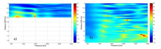
Figure 6 - Insertion Loss (dB) misurato all'interno del cristallo sonico nelle direzioni trasversale (a) e longitudinale (b). Frequenza sull'asse x, spostamento all'interno del cristallo sull'asse y - Insertion Loss (dB) measured inside the sonic crystal in the transverse (a) and longitudinal (b) directions. Frequency on the x-axis, displacement inside the crystal on the y-axis.
