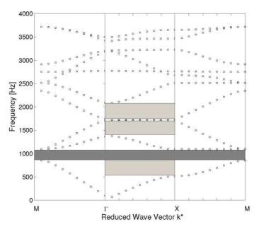
Figure 4 - Curve di dispersione per un reticolo quadrato di cilindri con Lc=0.20 m e r=0.08 m calcolate con il metodo PWE - Dispersion curves for a square array of cylinders with Lc=0.20 m and r=0.08 m evaluated using the PWE method.
