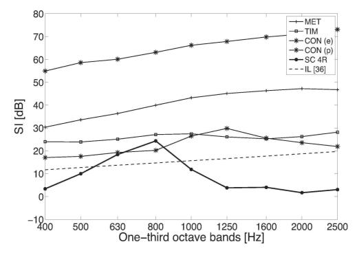
Figure 10 - Confronto fra gli indici SI misurati per un cristallo sonico da 4 file di cilindri (SC, [60]) e per barriere tradizionali [61] - Comparison between the Sound Insulation index measured for a 4-rows sonic crystal (SC, after [60]) and standard noise barriers, after [61].
