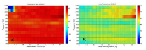
Figure 9 - Livelli di intensità e di pressione sonora (dB) misurati sul retro del campione. La sorgente si trova a destra dell'area del grafico - Sound intensity and sound pressure levels (dB) measured on the rear of the sample. The source is to the right of the plot areas.
