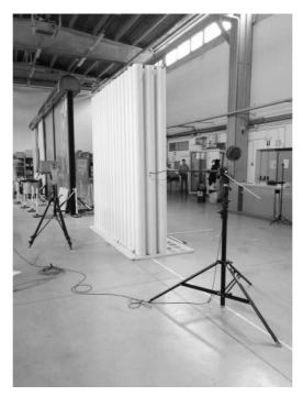
Figure 3 - Allestimento della catena di misura presso il Laboratorio di Acustica dell'Università di Bologna - Measurement setup at the Acoustic Laboratory of the University of Bologna.
