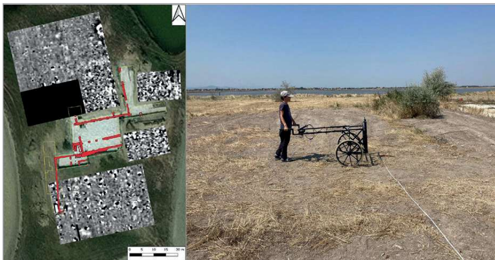
fig. 8.3.7 – Indagini geomagnetiche a Prato della Rosa. Risultati preliminari e attività sul campo con il gradiometro Foerster Ferex 4.0434 (Università di Bologna).
