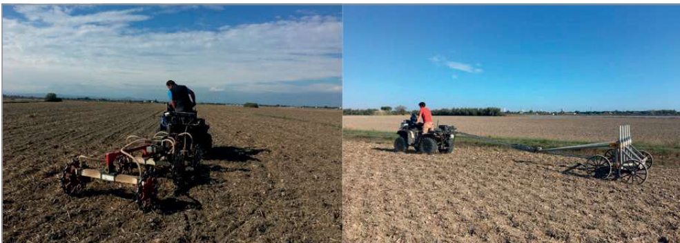
fig. 8.3.2 – Tecnologie ARP (Automatic Resistivity Profiling) e AMP (Automatic Magnetic Profiling) di Geocarta Inc. (Parigi) in azione nel sito di Cervia Vecchia.
