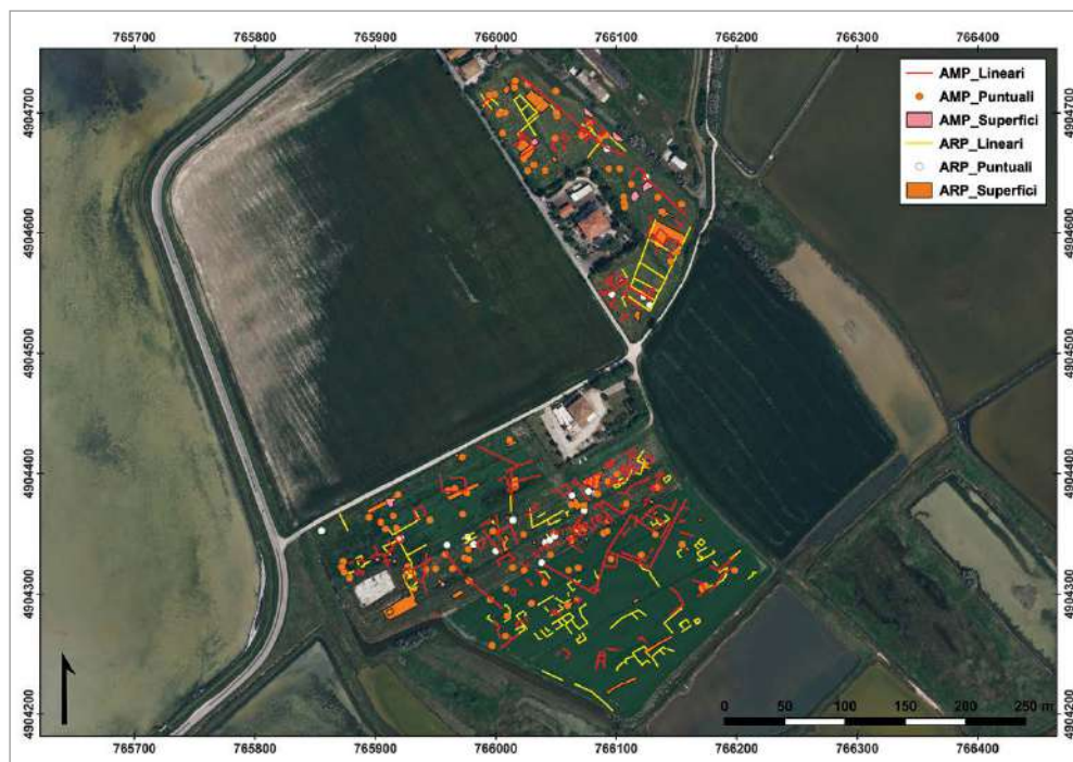
fig. 8.3.5 – Interpretazione complessiva e integrata delle principali anomalie geofisiche da magnetometria (AMP) e da geoelettrica (ARP).
