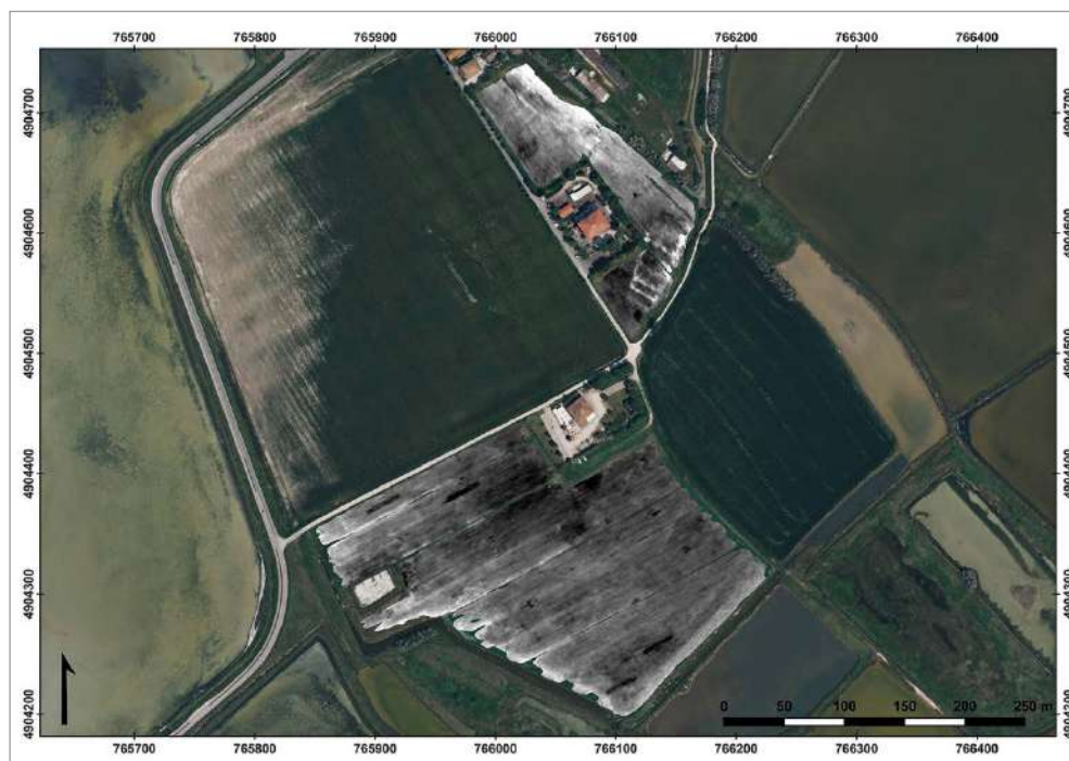
fig. 8.3.3 – Mappa di resistività elettrica ottenuta con il sistema ARP© nell'area urbana di Cervia Vecchia.
