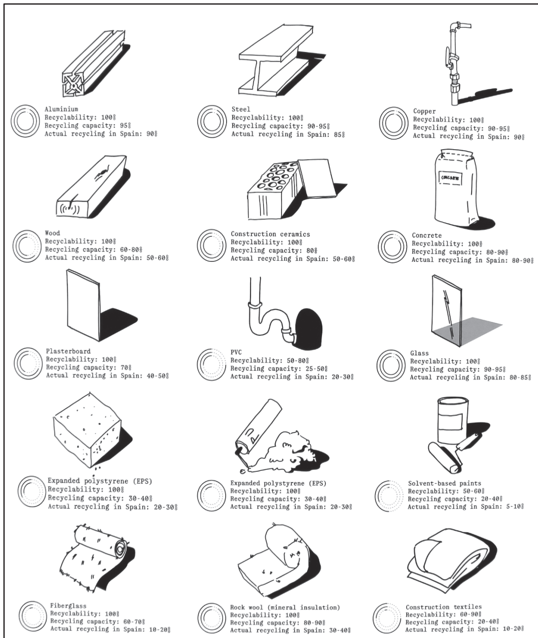
Figura 7.3 – Indice di riciclabilità dei materiali da costruzione più diffusi, esposto alla Biennale di Architettura 2025 all'interno del Padiglione spagnolo.
