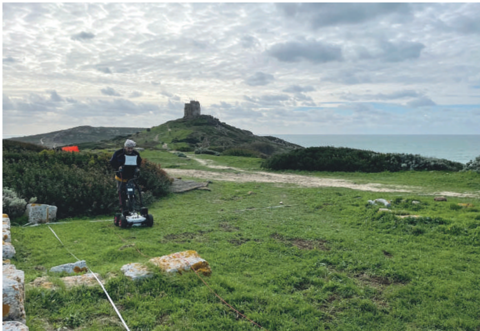
Fig. 76 – Tharros, settore orientale del cardo maximus. Rilievo georadar con la strumentazione IDS Hi-Mod Ris One, antenna 600-200 MHz
