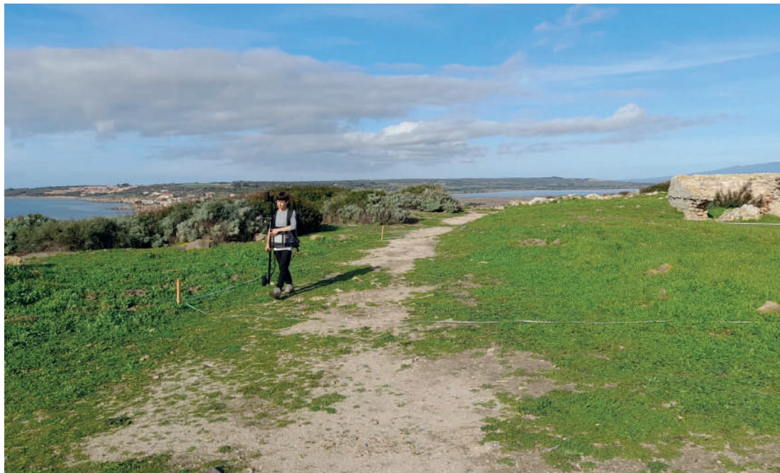
Fig. 75 – Tharros, settore orientale del cardo maximus. Survey geomagnetico con gradiometro al potassio GEM Systems GSMP-35
