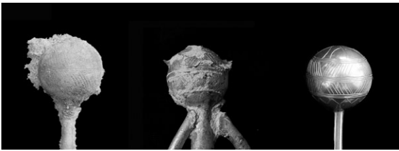
Fig. 9. Confronto tra le teste di spillone tipo Franzine realizzate in sabbia (a sinistra), a cera persa (al centro), e dopo la rifinitura (a destra).
