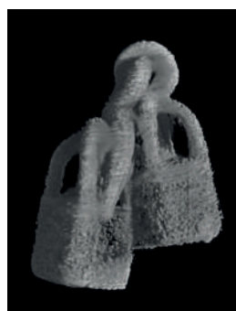
Fig. 32 – Orecchini agganciati a forma di cestello. Rappresentazione tridimensionale della ricostruzione tomografica (Elab. M. BETTUZZI)
