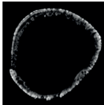
Fig. 30 – Sezione assiale del vago cilindrico che mostra la lamina esterna e lo spessore di corrosione all'interno (Elab. M. BETTUZZI)
