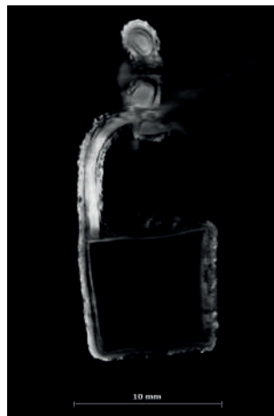
Fig. 26 – Sezione verticale del cestello che mostra la lamina metallica interna piuttosto sottile e lo strato di corrosione più spesso all'esterno (Elab. M. BETTUZZI)
