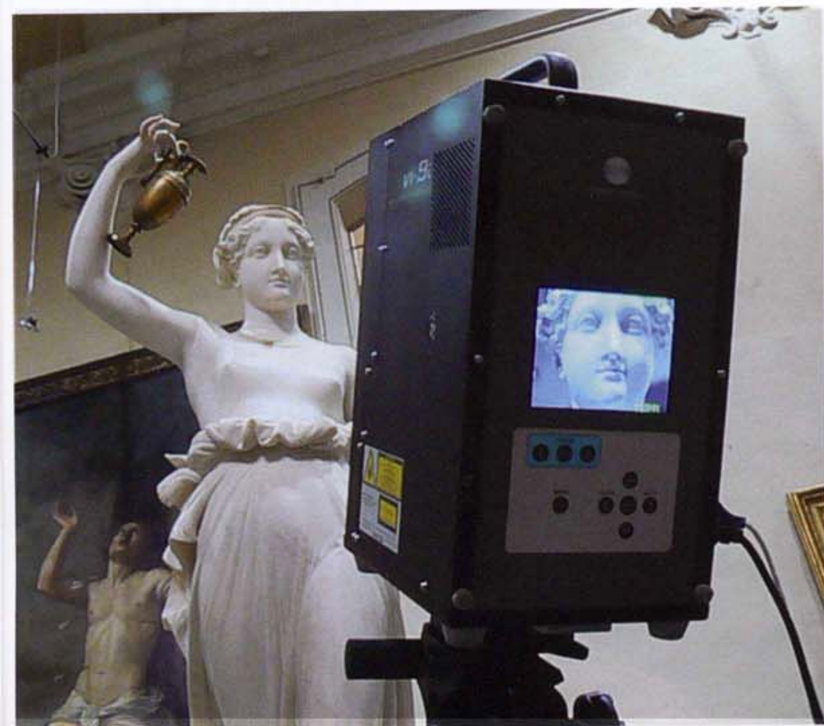
Figura 2. Scansione 3D della testa della statua tramite il laser scanner Konica Minolta Vivid 9i.
