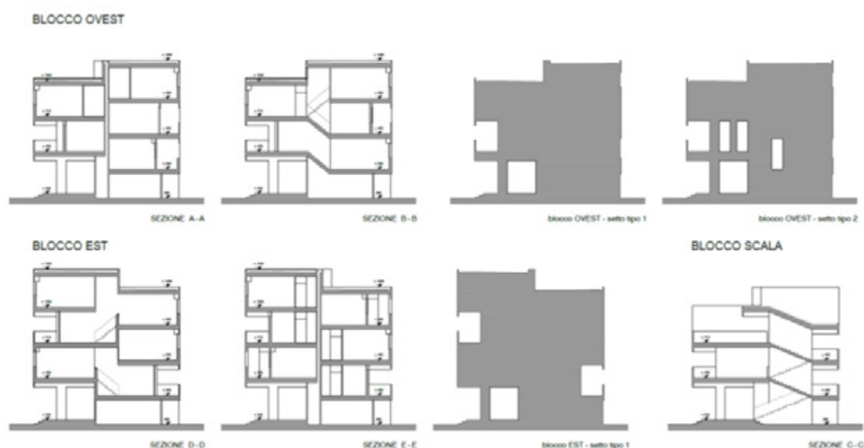
Fig. 3. Concezione strutturale dell'edificio. Individuazione delle solette di piano, delle scale interne e di quelle esterne. Rappresentazione schematica dei differenti setti trasversali sia del blocco est che del blocco ovest. – © 2019, Prati.
