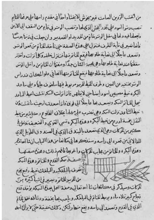
Fig. 7: Diagramma del pesce in legno che si muove su e giù lungo un filo grazie a una puleggia (2.3.7). Al-Zarhūri, Kitāb zahr al-basātīn (Il libro dei fiori dei giardini), MS Leiden Or. 119, p. 41. (Foto: Lucia Raggetti)
