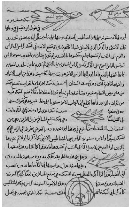
Fig. 6: Diagrammi che rappresentano alcune delle figurine semoventi di al-Zarhūrī: i due pesci che salgono in superficie e vanno a fondo (2.3.3), pesce che contiene un ago magnetizzato (2.3.4) e il pesce che indica la qibla ; in alternativa, questo dispositivo può prendere la forma di un dischetto su cui è raffigurato un mihrab (2.3.6). Al-Zarhūrī, Kitāb zahr al-basātīn ('Il libro dei fiori dei giardini'), MS Leiden Or. 119, p. 40. (Foto: Lucia Raggetti)
