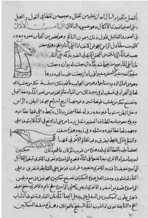
Fig. 5: Diagrammi che rappresentano un semplice automa e una figurina semovente di al-Zarḥūrī: la 'scimmia' che sbuffa (2.3.1) e il pesce di legno che emerge dall'acqua (2.3.2). Al-Zarḥūrī, Kitāb zahr al-basātīn (Il libro dei fiori dei giardini), MS Leiden Or. 119, p. 39. (Foto: Lucia Raggetti)
