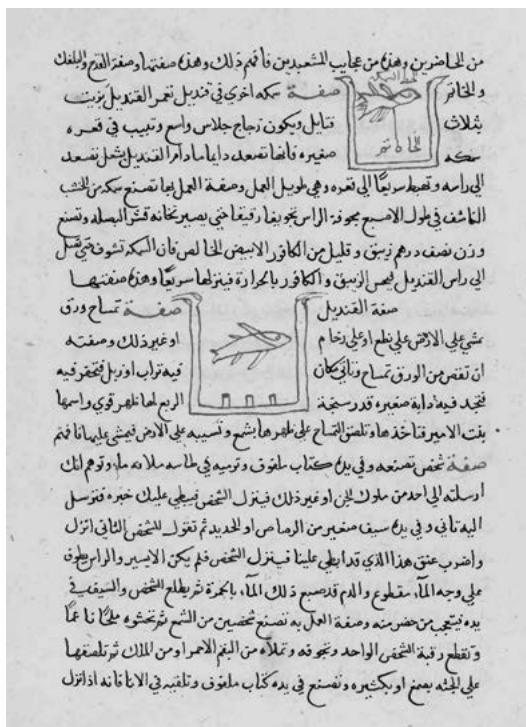
Fig. 8: Sezioni del recipiente d'acqua in cui un pesce si muove lungo un filo (2.3.8) e del recipiente in cui bruciano tre stoppini mentre un pesce va su e giù (2.3.9). Al-Zarhūrī, Kitāb zahr al-basātīn ('Il libro dei fiori dei giardini'), MS Leiden Or. 119, p. 42. (Foto: Lucia Raggetti)
