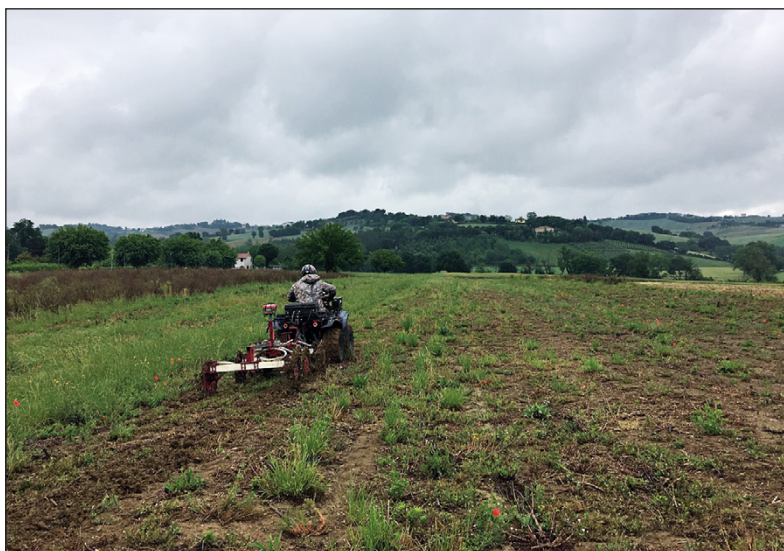
Fig. 5 – Una fase del rilevamento sul campo con il sistema di resistività estensiva e autotrainata ARP (in collaborazione con Geocarta Inc. Parigi). Nella foto il dott. Giovanni Bitella.
