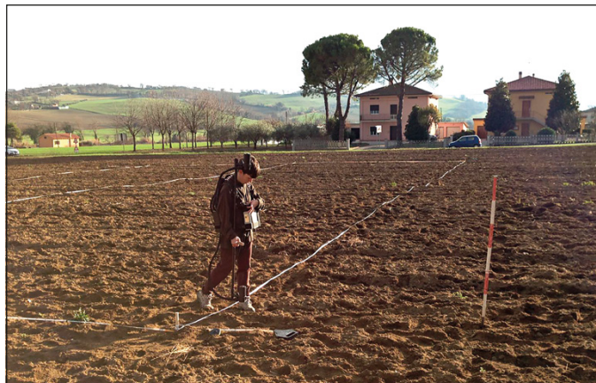
Fig. 7 – Indagine gradiometrica con il magnetometro-gradiometro al potassio Gem Systems GSMP-35. Acquisizione ed elaborazione dati dell'autore.
