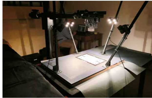
Fig. 4. La soluzione della struttura che regge il sistema di illuminazione e ospita il disegno con la colonna che porta la macchina fotografica digitale a scansione Rencay DiRECT Camera Systems 24k 3 in posizione di lavoro al Gabinetto Disegni e Stampe degli Uffici.
