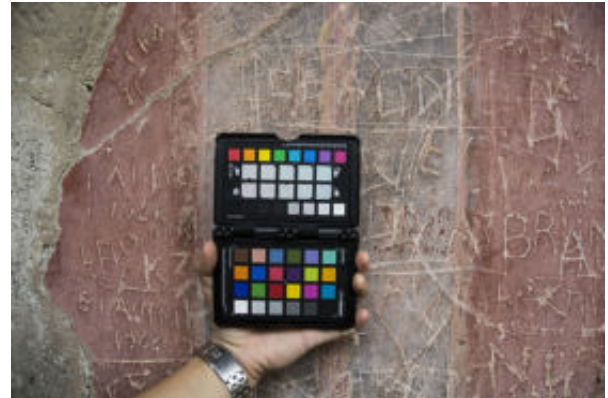
3. Il target di colori codificati impiegato per una migliore riproduzione cromatica delle superfici pittoriche
