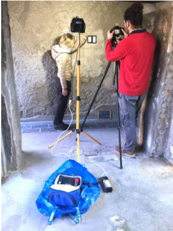
2. Ercolano, Parco archeologico. Studenti impegnati nelle operazioni preliminari al rilievo fotogrammetrico: la calibrazione del bianco (fotografia A. Fiorini, 2016)
