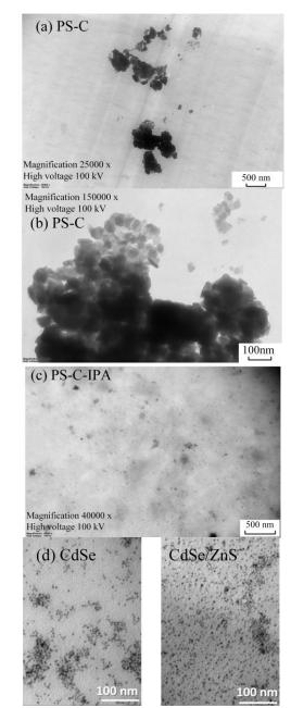
Figure 1. TEM images of: (a) and (b) PS-C, (c) PS-C-IPA, (d) quantum dots.
