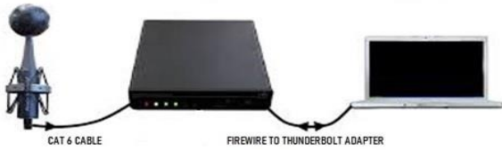
Fig. 3. Eigenmike system layout
