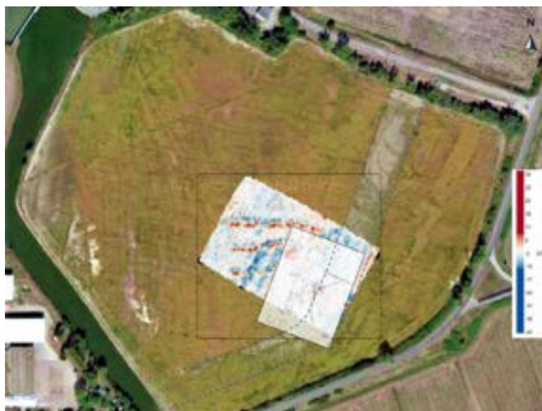
Figura 5 - Bocca delle Menate, Comacchio. Sull'immagine satellitare dell'area, la sovrapposizione della mappa gradiometrica e dello schizzo planimetrico della villa; in tratteggiato il canale di bonifica. Si osservino la coincidenza dell'anomalia circolare con la cisterna a NO dell'area scavata.
