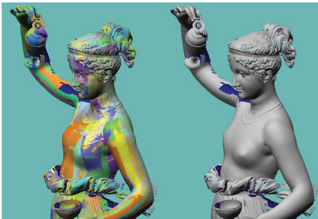
Figura 5 - A sinistra: insieme delle scansioni registrate (visualizzate in colori diversi) ottenute tramite il T-Scan. A destra: modello digitale 3D dell' Ebe ottenuto dalla fusione delle precedenti scansioni.
