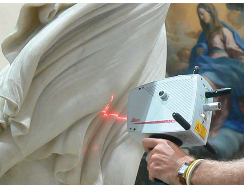
Figura 4 - Scansione 3D della statua tramite il T-Scan del sistema di misura integrato.
