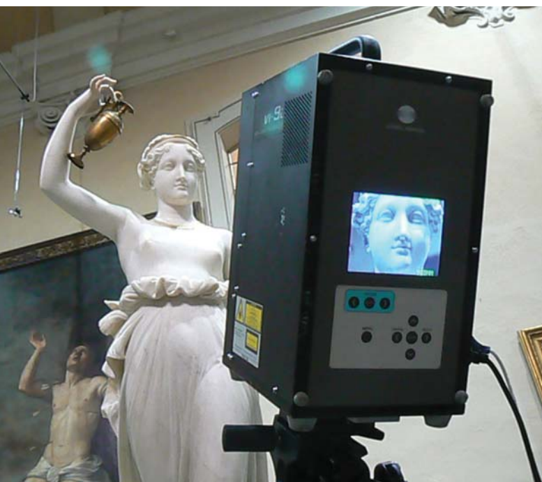
Figura 2. Scansione 3D della testa della statua tramite il laser scanner Konica Minolta Vivid 9i.
