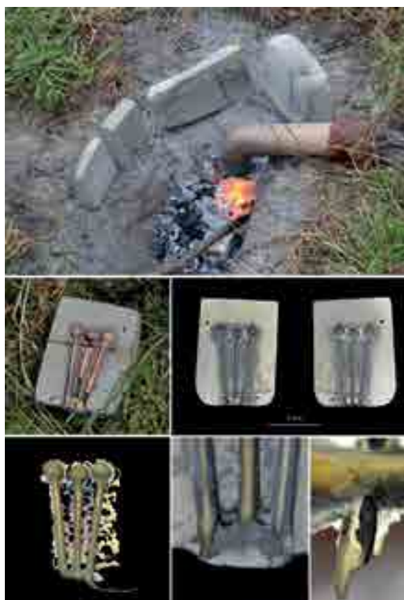
Fig. 15. Operazioni di colatura e semilavorati ottenuti.
