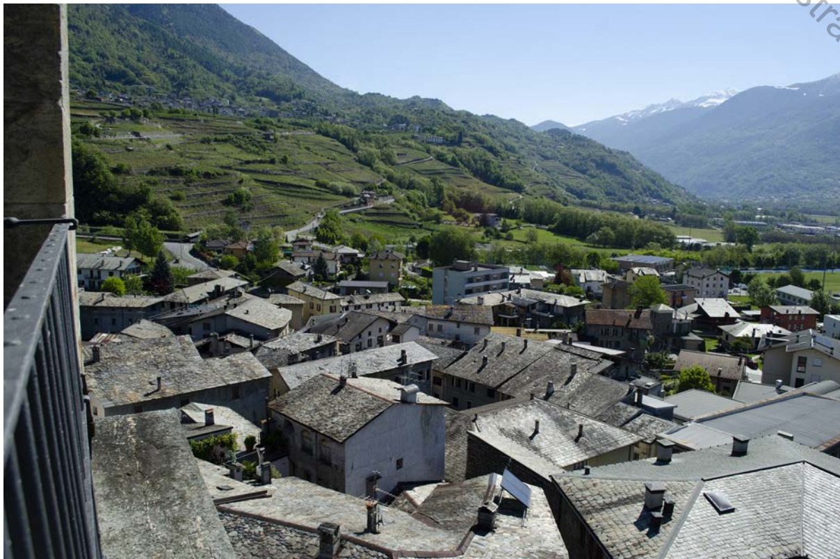
Figura 1. Panorama di Chiuro dal campanile della Chiesa dei SS. Giacomo e Andrea: sullo sfondo il paesaggio terrazzato per la coltivazione della vite, in primo piano le coperture del centro storico in lastre di pietra serpentinosi, che caratterizza colori e superfici anche delle pavimentazioni del centro storico.
